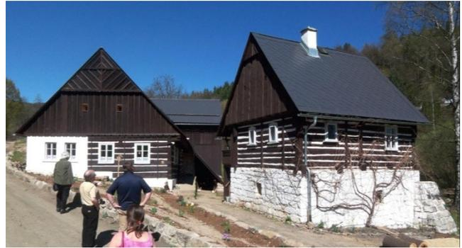
Abb. E-7: prägender Blockbau, Wohnhaus und Speicher mit unterlagertem Stall, Malá Skála
