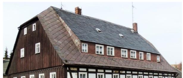
Abb. C-39 am First ansetzende lange **Schleppgaube** in Neugersdorf
